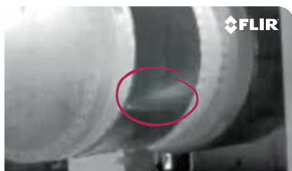
Erfasstes Gasleck an einem Produktionsstandort.
