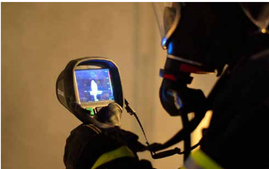
Eine Wärmebildkamera muss sich auch mit Schutzhandschuhen einfach einhändig bedienen lassen.
