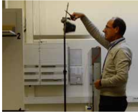
Die Norm 1801-2013 umfasst Anforderungen an die Robustheit, die gewährleisten sollen, dass die betreffenden WBKs den typischen Arbeitsbedingungen von Feuerwehrleuten gewachsen sind. Von links nach rechts: Härtetest (Schleudertest), Stoßfestigkeitstest (Falltest) und Hitze- und Flammenwiderstandstest.
