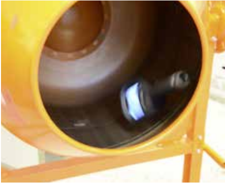
Die Norm 1801-2013 umfasst Anforderungen an die Robustheit, die gewährleisten sollen, dass die betreffenden WBKs den typischen Arbeitsbedingungen von Feuerwehrleuten gewachsen sind. Von links nach rechts: Härtetest (Schleudertest), Stoßfestigkeitstest (Falltest) und Hitze- und Flammenwiderstandstest.
