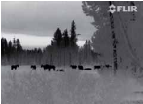
Bei der handlichen Wärmebildkamera FLIR Scout TS32 Pro kann der Benutzer wählen, ob auf dem Wärmebild heiße Gegenstände weiß oder schwarz erscheinen sollen.
