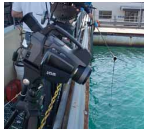
Diese Wärmebildkameras sind aus verschiedenen Winkeln auf Ölspuren im OHMSETT Becken gerichtet.
