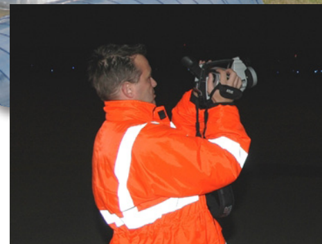
Thermograf Ralf Grispes benutzt die FLIR P660 Wärmebildkamera, um die Isolierung von Rohrleitungen zu untersuchen.
